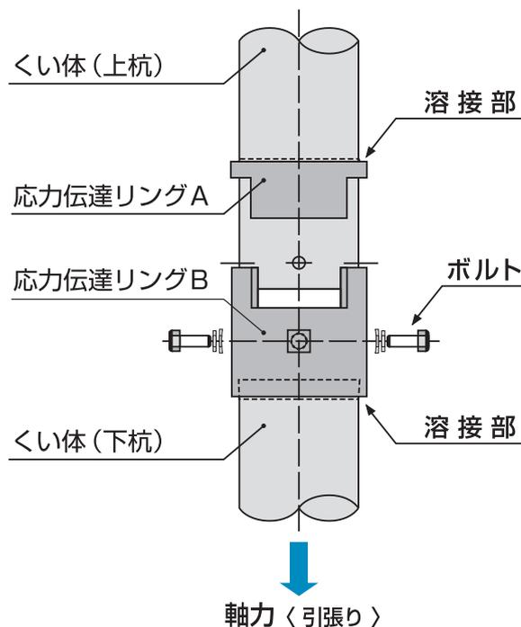
軸方向の引張力は、ボルトで伝達される。
