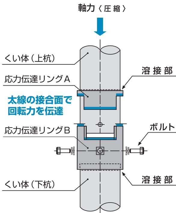
軸方向の圧縮力は、応力伝達リング端部の接合面で伝達される。
