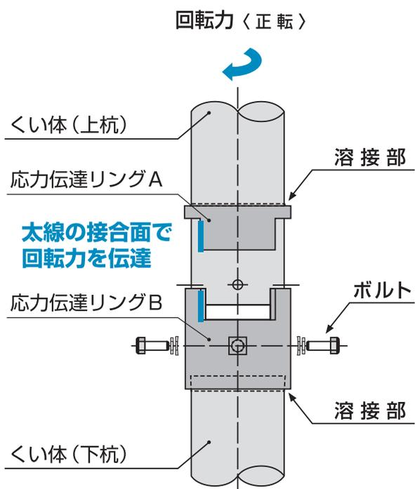
正回転方向のねじり力は、応力伝達リングの回転方向接合面で伝達される。
