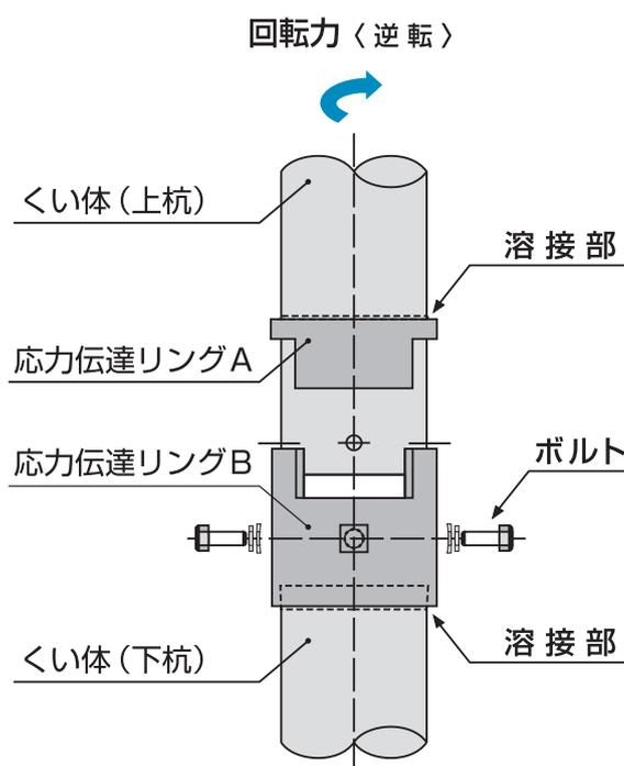
逆回転方向のねじり力は、ボルトで伝達される。
